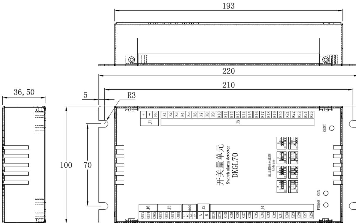
图1 KGL70 监控模块外形尺寸（单位：mm）
